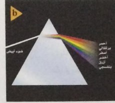
الشكل 6-11 يسقط ضوء أبيض على منشور فيتفرق (يتحلل) إلى حزم من ألوان مختلفة (a). وتتحرف الألوان المختلفة من الضوء بدرجات مختلفة عند عبورها وسطاً ما (b).
