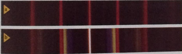
الشكل 12-14 استخدم محزوز لإنتاج أنماط الحيود للضوء الأحمر (a) وللضوء الأبيض (b).
