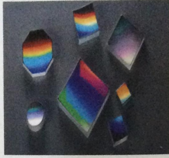
الشكل 11-12 تستخدم محزوزات الحيود لتكوين أنماط الحيود من أجل تحليل مصادر الضوء.
