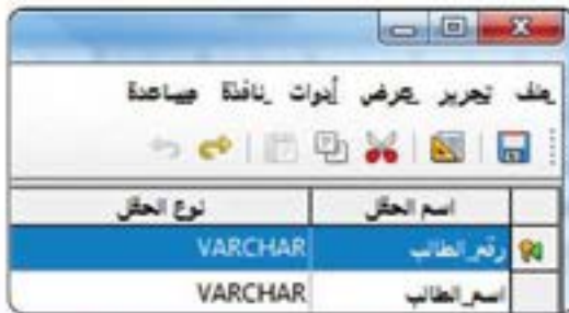
شكل (٩-٢-٢): علامة المفتاح تدل على أن حقل رقم الطالب هو المفتاح الأساسي الآن
