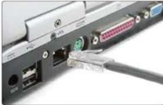
شكل (1-1-1): توصيل الحاسب بكيبل بمقبس (RJ45) للشبكة المحلية
