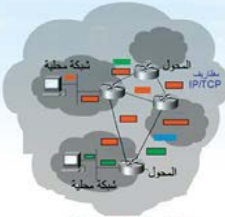
شكل (11-1) نقل وتبادل المطروف بين المحولات باستخدام مداولة (IP)
