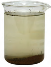
تتفصل أجزاء المخلوط بعضها عن بعض بسبب اختلاف الكثافة.
