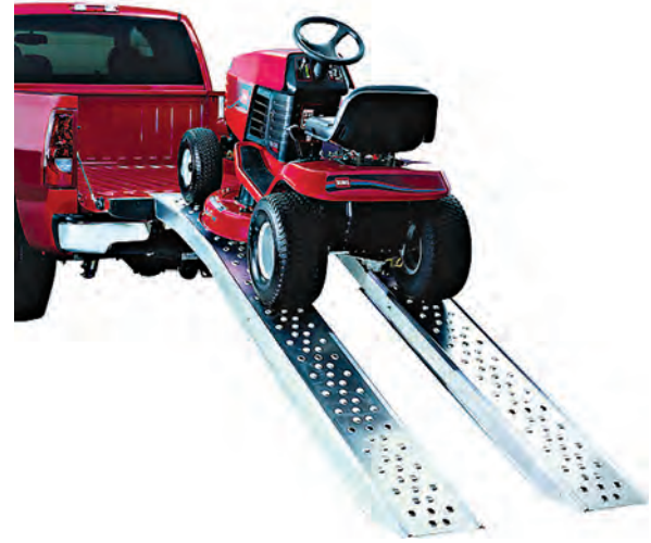
الشكل ١٩ تمثيل هذه العربة في الشاحنة أسهل باستعمال السطح المائل. وبالرغم من دفع العربة مسافة أطول فإنه يلزم قوة أقل.
