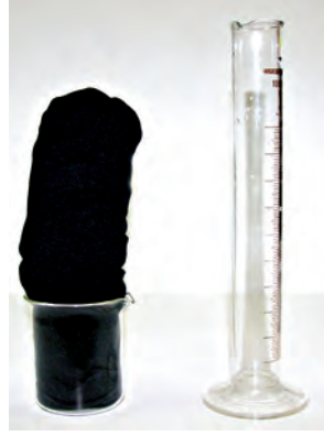
الشكل ١١ عندما يتفاعل السكر مع حمض الكبريتيك يحدث تغير كيميائي وتكون مادة جديدة. وينطلق غاز سام ويبقى فقط الماء والكربون.
