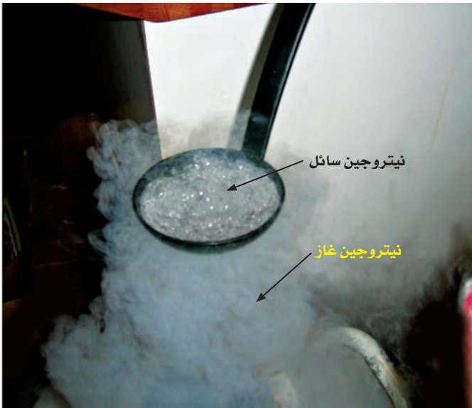
الشكل ٦ يتحول النيتروجين المسال إلى غاز فور تعرضه لحرارة الغرفة، فدرجة غليان النيتروجين (-١٩٥,٨°س) أقل بكثير من درجة حرارة الغرفة.
