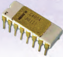
شكل (٣-٦): المظهر الخارجي للميكروبرسر (4004)
