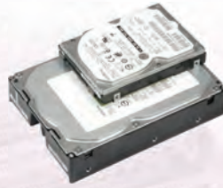
شكل (١٠-٦): محركات الأقراص الصلبة (hard drive) بمقاسها (3.5) بوصة، و(2.5) بوصة
