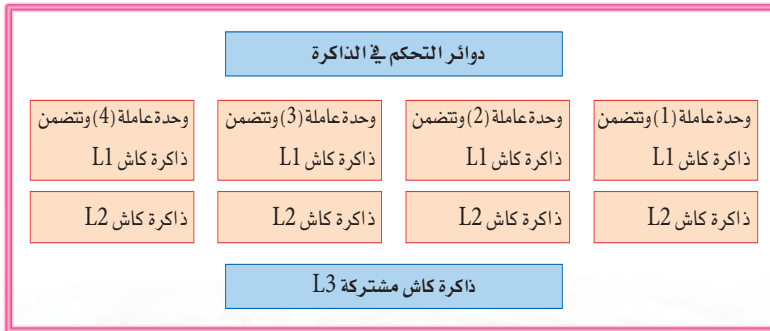
شكل (٥-٦): نموذج مبسط للبنية الداخلية لمعالج متعدد الوحدات (multi-core)
