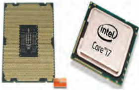
شكل (٤-٦): المعالج (Core i7). مع إيضاح صورة سطح ومظهر المعالج
