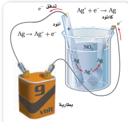
الشكل 7-23 هناك حاجة إلى الطاقة لتأكسد الفضة على الأنود واختزالها على الكاثود. وفي خلية التحليل الكهربائي المستعملة للطلاء بالفضة، يوضع الجسم أو الشيء المراد طلاؤه على الكاثود؛ حيث يتم اختزال أيونات الفضة في المحلول إلى ذرات الفضة، وترسب على الجسم.
