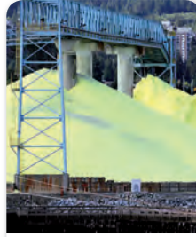
الشكل 5-9 الكبريت يتم استخراج الكبريت من مناجم البترول بواسطة عمليات كيميائية. كما يستخرج بدفع الماء الساخن إلى أماكن تجمعه تحت الأرض، فيُضخ الكبريت السائل إلى السطح.
