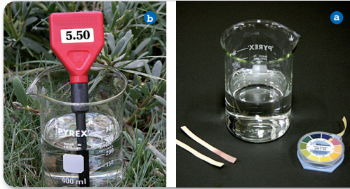
الشكل 5-18 يمكن الحصول على قيمة pH تقريبية للمحلول بوضع قطعة من ورق تباع الشمس الأحمر للمحلول، ومقارنة لونها بمجموعة من الألوان المعيارية، كما هو مبين في الصورة a. أما مقياس الحموضة الرقمي والموضح في الصورة b فيستعمل هنا لقياس pH لمحلول حمضي؛ إذ يعطي قياساً أدق من استعمال ورق تباع الشمس.
