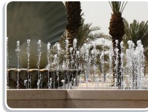
تستعمل النوافير مضخات تضخ الماء بزوايا محددة فتصنع أفواصاً. ويعتمد مسار الماء على سرعة الضخ وزاويته. فعندما يتم ضخ الماء في الهواء بسرعة  $v$ ، وزاوية مع الخط الأفقي مقدارها  $\theta$ ، فإن المعادلتين الآتيتين تحددان المسافة الأفقية  $D$ ، وأقصى ارتفاع  $H$ :
