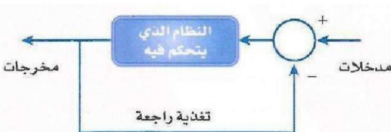
إن آلية عمل نظام ضخ الماء هي أن يقوم المستخدم بضبط قوة الضخ المطلوبة في البداية وتكون هذه المعلومة هي مدخل نظام التحكم ثم يقوم بعدها جهاز الضخ بقياس قوة إندفاع المياه وتعديل قوة الضخ حسب الاندفاع.
