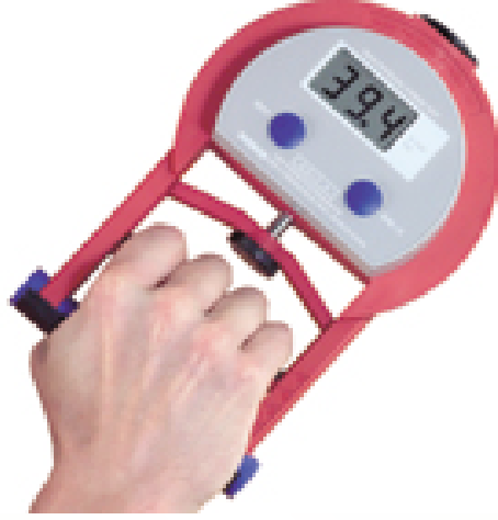
شكل (٢) جهاز ديناموميتر لقياس قوة القبضة
