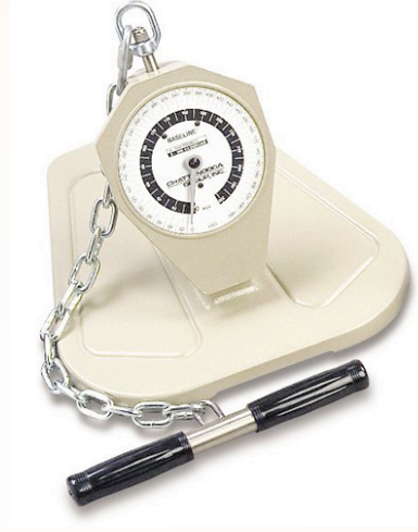
شكل (٢) جهاز ديناموميتر لقياس قوة عضلات الفخذين والظهر
