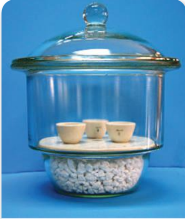
الشكل 18-2 يجفف كلوريد الكالسيوم الهواء من جزيئات الماء. كما يستعمل في المختبر في حفظ المواد الكيميائية من رطوبة الجو.
