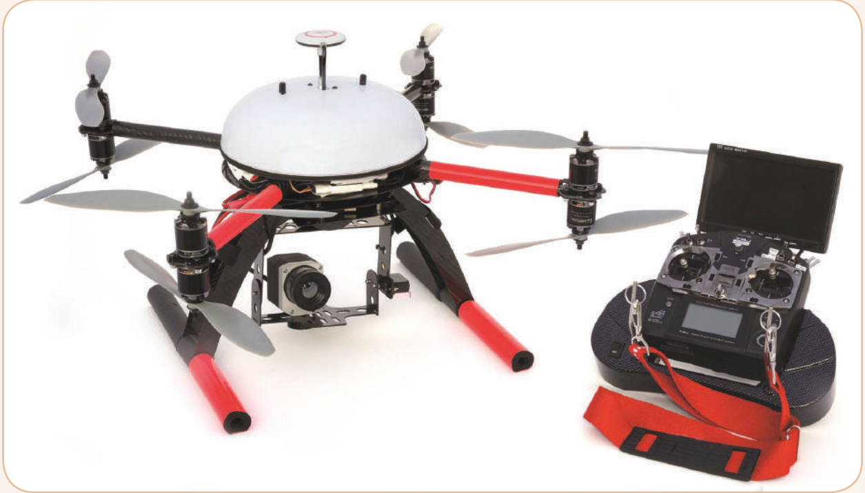
استخدام طائرة بدون طيار في أعمال المساحة
