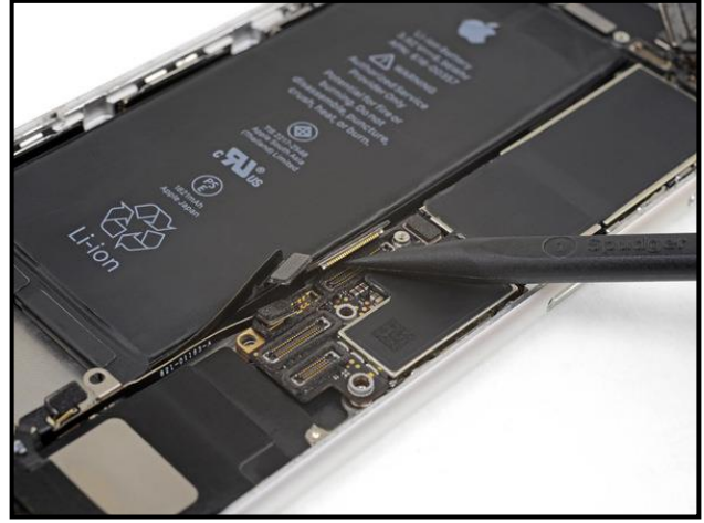
٤٩- استخدام نقطة من spudger لرفع الموصلات حتى تتمكن من تحرير اللوحة الام
