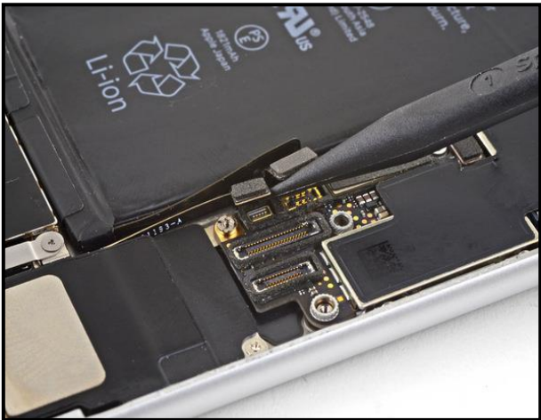
٤٨- استخدم نقطة spudger لرفع وفصل كبل هوائي لـ Wi-Fi.
