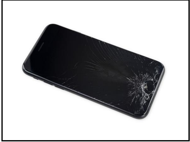
٥٣- الشكل يوضح الشاشة بها كسر ويتم لصق لاصق على أماكن الكسر .
