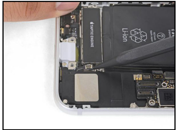
٢٣- حرر برفق موصل كابل الهوائي باستخدام الأداة الموضحة بالشكل
