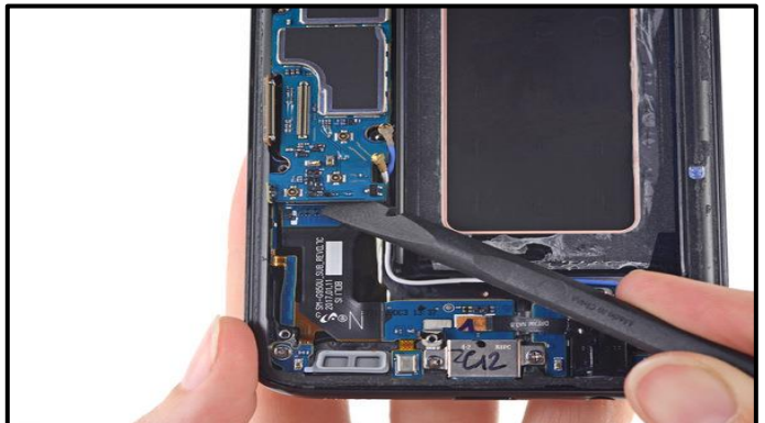
٢٢- استخدم الطرف المسطح من spudger لرفع اللوحة الأم وفصلها عن الشاسيه
