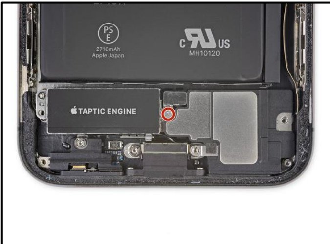
١٨- قم بإزالة المسمار ٢,١ مم Y000 الذي يثبت غطاء موصل السماعة.
