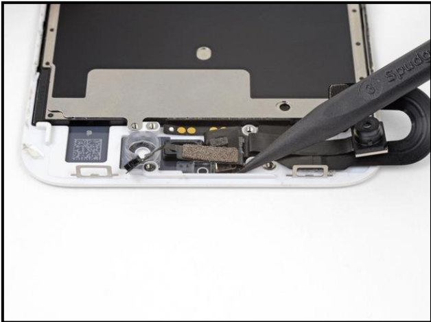
٦٤- قم بتحريك الطرف المقوس الموجود أسفل كابل الإضاءة المستشعر التقارب ، وارفع المستشعر من مكانه
