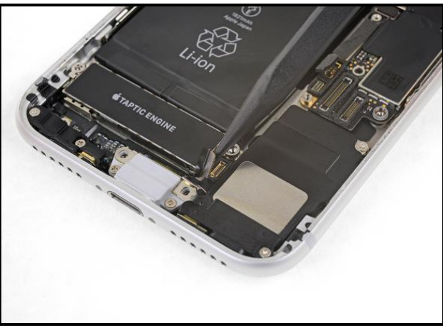
٢٤- حرر برفق موصل كابل موديول الهزاز حتى يمكنك رفعه بشكل كامل من الجهاز
