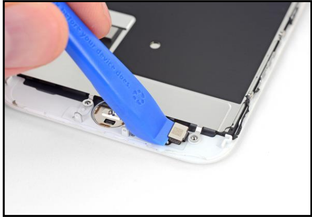
٥٥- استخدم أداة فتح للنقر تحت الحافة اليسرى لموصل كابل زر الشاشة الرئيسية لفصله من المقبس
