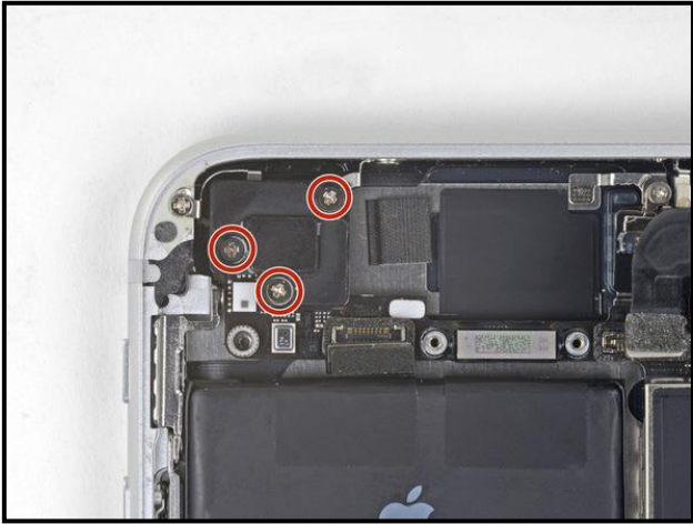
٤٠- قم بفك مسامير Phillips ١,٣ مم لتثبيت المكون العلوي الأيسر للهوائي
