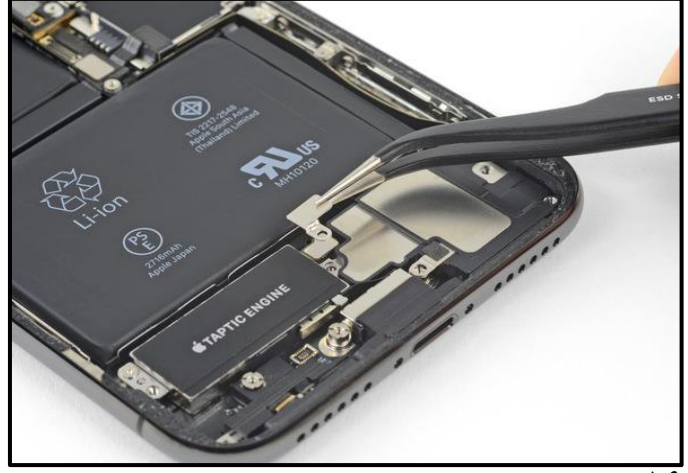
١٩- قم بإزالة غطاء موصل السماعة. مستخدماً الملقط في عملية الرفع
