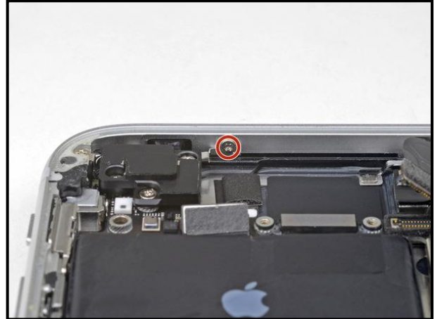
٤١- قم بإزالة المسامير ١,٤ ملليمتر Phillips الذي يثبت مودبول الهوائي إلى أعلى حافة العلبة
