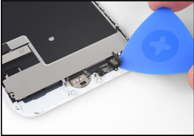
٥٦- استخدم أداة الفتح لفصل اللاصق لكابل مستشعر البصمة وزر الهوم يمكنك استخدام المسدس الحراري إذا لزم الأمر لإذابه الغراء المثبتة للكابل
