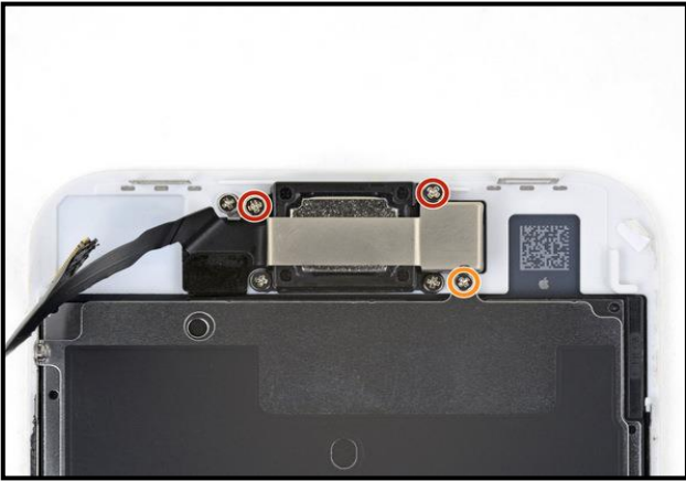
٥٨- قم بإزالة مسامير Phillips الثلاثة التي تثبت دعامة السماعة إلى اللوحة الأمامية
