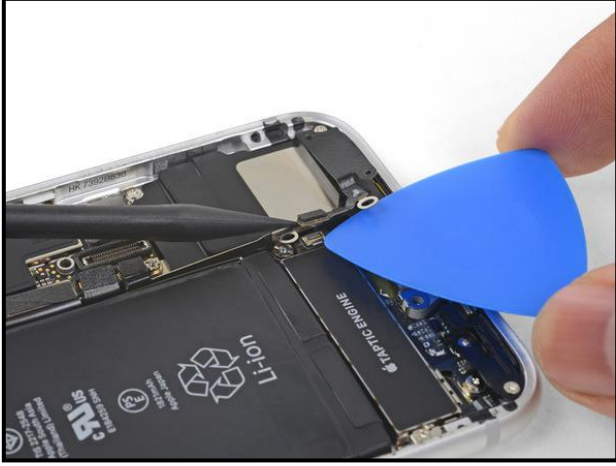
٢٠- حرر بشكل كامل كابل الهوائي Wi-Fi. استخدام مسدس الهواء الساخن إذا احتاج الامر لذلك
