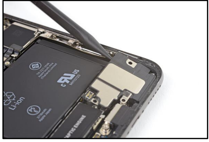
٢١- قم بإدخال spudger تحت الحافة العلوية للسماعة من حافة علبة ال iPhone. قم برفع الحافة العلوية للسماعة وارفعها برفق.
