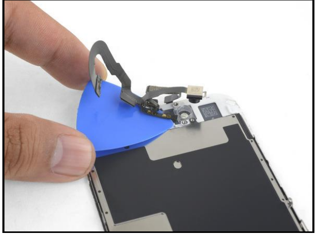
٦٥- قم بتمرير أداة الفتح المبينه أمام مجموعة كابل الكاميرا الأمامية ، مع فصل المادة اللاصقة التي تمسك بالكاميرا وكابل المستشعر
