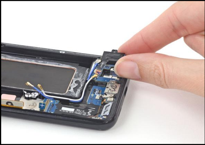
٢٩- أرفع مقبس سماعة الرأس باستخدام يدك
