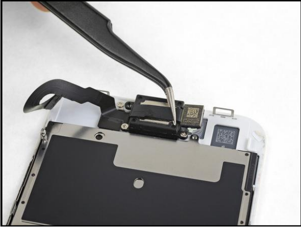
٦٠- ارفع الكاميرا الامامية من مأخذ التيار الخاص بها وقم بإزالتها
