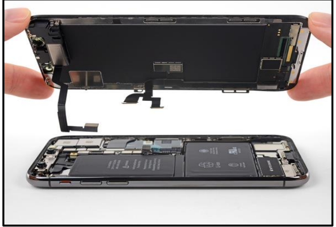
١٣- مستخدماً يديك ارفع الجزء العلوي للجهاز ( الشاشة )
