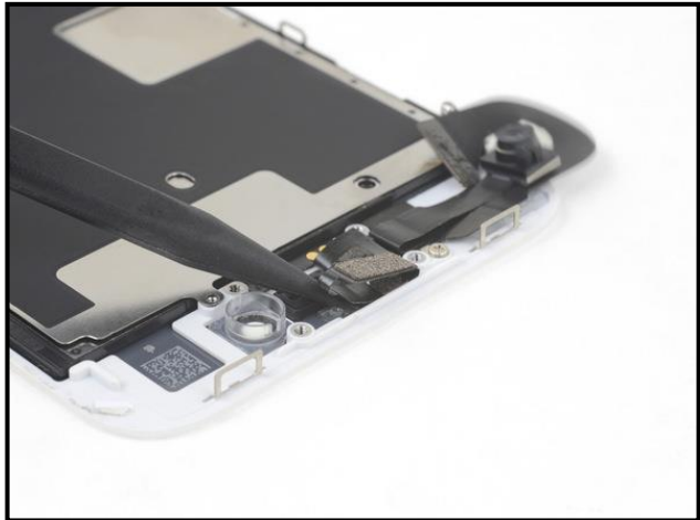
٦٣- استخدام نقطة من spudger لرفع مستشعر القرب بلطف للخروج من مكانه على اللوحة الأمامية
