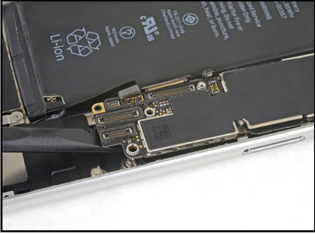
٥٠- استخدم الطرف المسطح من spudger وبقرف لرفع اللوحة الام
