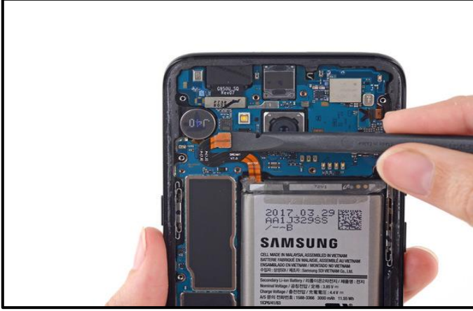
١٤- استخدم النهاية المسطحة لأداة spudger لفصل موصل البطارية.
