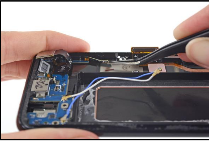
٣٣- استخدم الملقط لرفع كابل شريط الهوائي برفق من جانب العلبة.
