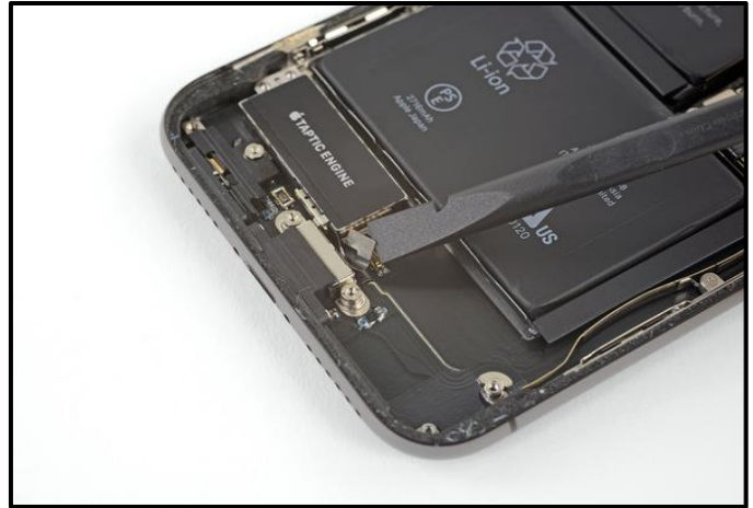
٢٣- استخدم أداة spudger لفصل الكبل المرن لمحرك الهزاز من خلال تحريكه بشكل مستقيم لأعلى من المقبس
