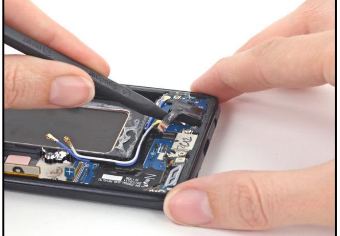
٢٨- استخدم أداة spudger لرفع مقبس سماعة الرأس من اللوحة.
