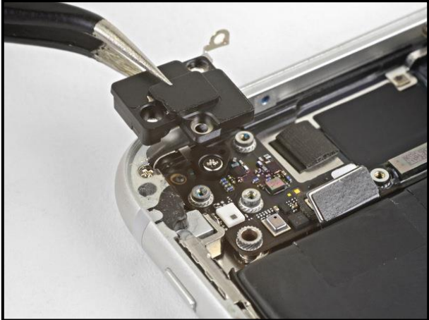
٤٢- حرر برفق مودبول الهوائي باستخدام الملقط
