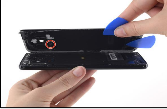
٧- كل مرة توجد فيها ثغرة ضع أداة الفتح لمنع إعادة الالتصاق مرة أخرى . ٨- بعد الانتهاء من عملية الفتح أرفع الغطاء برفق مستخدماً يديك كما بالشكل
