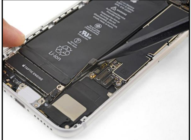
١٩- باستخدام الاداه الموضح حرر موصل كابل الهوائي Wi-Fi من على اللوحة الام
