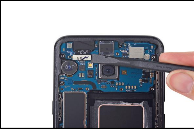
١٩- استخدم النهاية المسطحة للأداة spudger لفصل موصل الكاميرا الأمامي.
