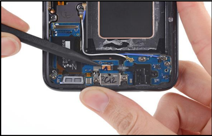
٢٧- استخدم أداة نقطة spudger لفصل موصل مقبس سماعة الرأس.
