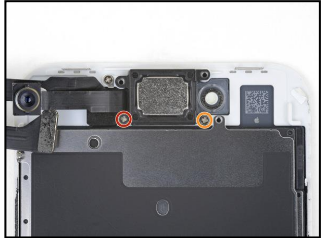
٦١- قم بفك مسامير Phillips الثنائية التي تثبت سماعة الأذن في اللوحة الأمامية
