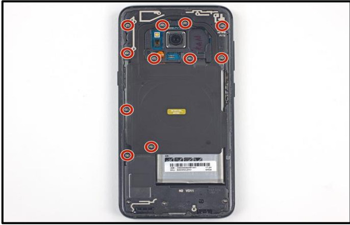
٧- كل مرة توجد فيها ثغرة ضع أداة الفتح لمنع إعادة الالتصاق مرة أخرى . ٨- بعد الانتهاء من عملية الفتح أرفع الغطاء برفق مستخدماً يديك كما بالشكل
