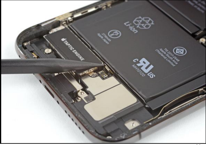
٢٠- استخدم طرف spudger لرفع موصل السماعة وافصله. كما هو مبين بالشكل
