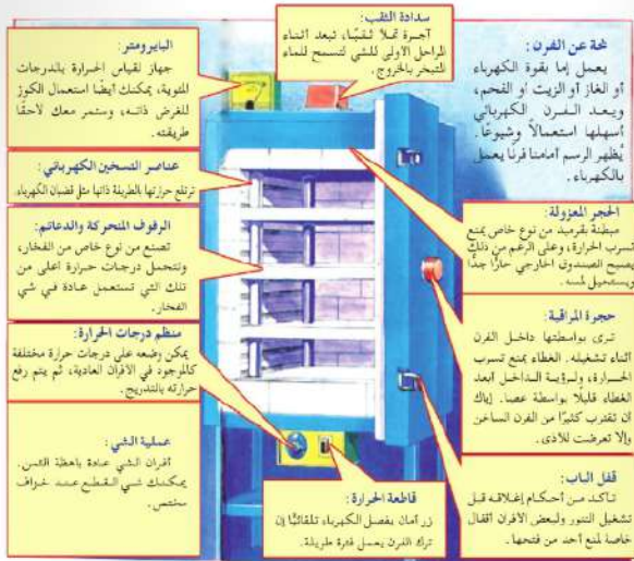
الشكل (٥٩) : الأفران الحديثة أو الكهربائية والأجزاء التي تتكون منها.
