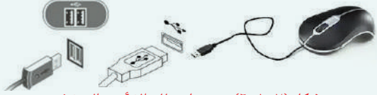
شكل (٦-١-٢): توصيل سلك الفأرة بالمنفذ المناسب له في صندوق الحاسب
