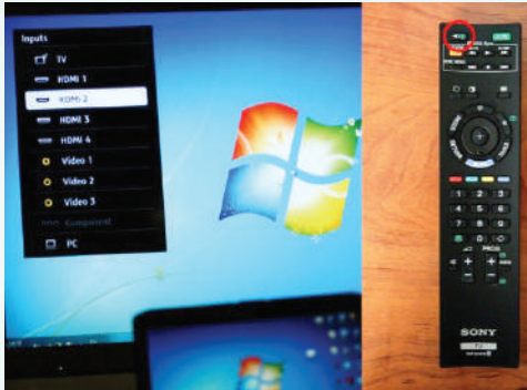
شكل (٢-١١): ضبط إعدادات العرض في جهاز التلفاز من خلال جهاز التحكم عن بعد
