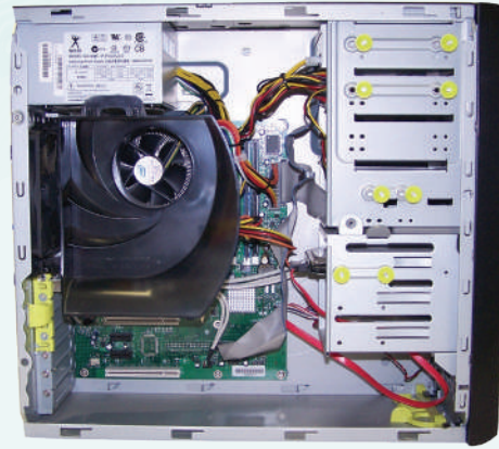
شكل (٤-٢): اللوحة الحاضنة داخل صندوق الحاسب
